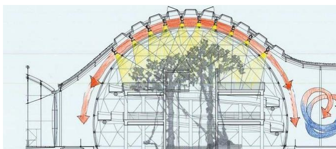
Рисунок 1. Общий вид циркуляции теплого воздуха в оранжерее
