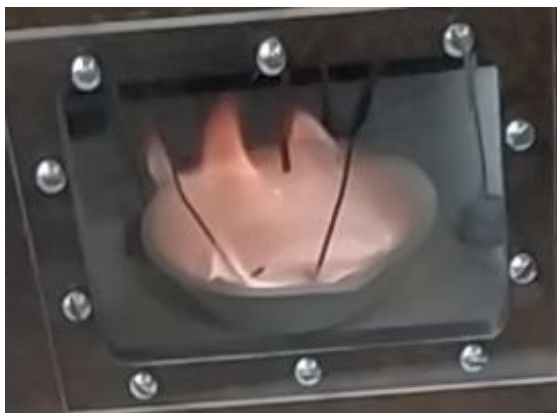
Рисунок 1. Горение электролита ЛИП-100А в воздухе
