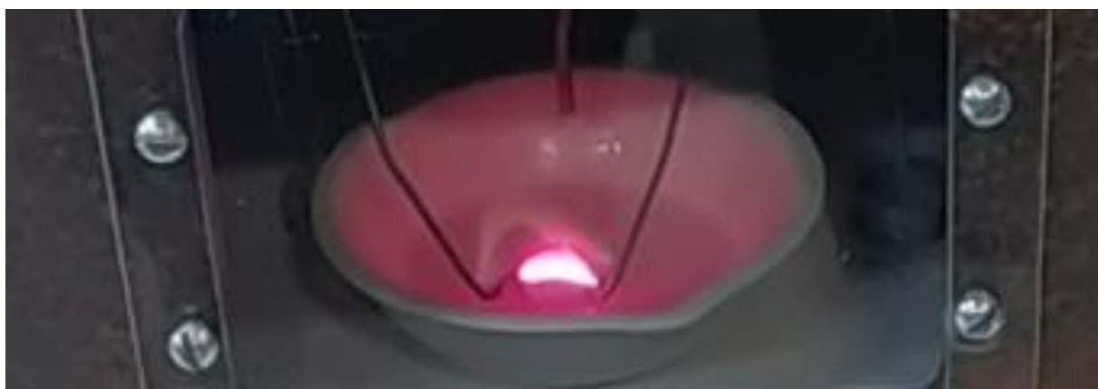
Рисунок 3. Отсутствие горения электролита ЛИП-100А при объемной доле кислорода 12,6 %
