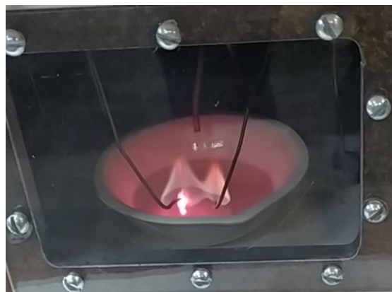
Рисунок 2. Горение электролита ЛИП-100А в среде с объемной долей кислорода 16,8 % в присутствии дуги
