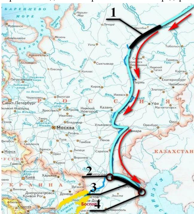
Рисунок 3. Схема переброски воды от Волгоградской ГЭС до низовьев реки Волга в Астраханскую области для орошения сельскохозяйственных земель без использования насосных станций.
