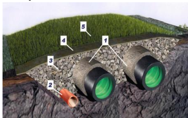
Рисунок 1. Наземная укладка магистральных водоводов в обваловке. 1-магистральные водоводы в теплоизолирующем слое; 2-дренажный трубопровод; 3-гравий; 4-геосетка; 5-газон
