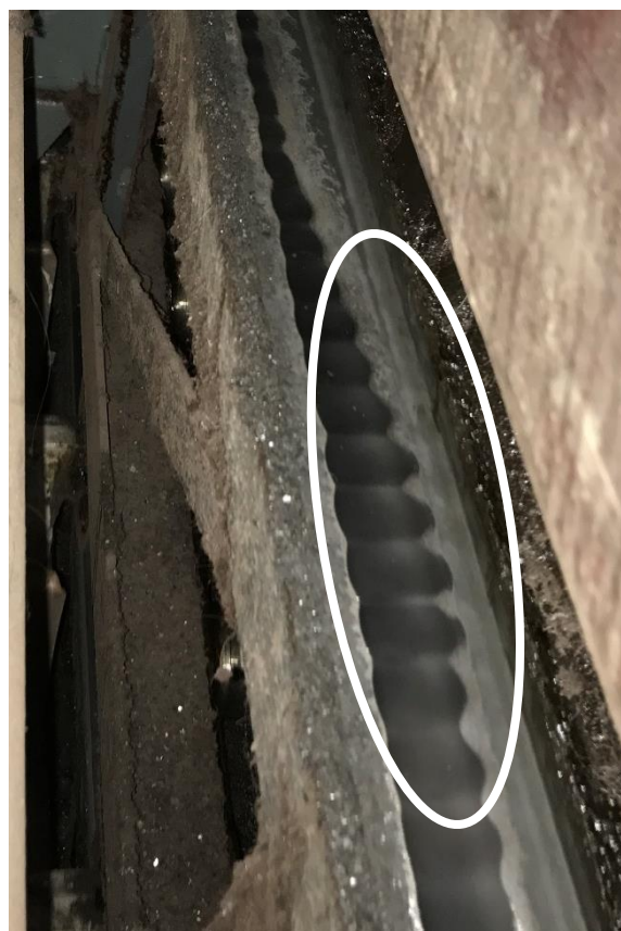
Рис. 4. Волнообразный износ направляющей бегунка ступени
