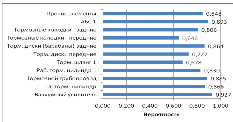
Рис. 3. Вероятность безотказной работы в течение года элементов тормозной системы транспортных средств и вклад в нее отдельных элементов машины.
