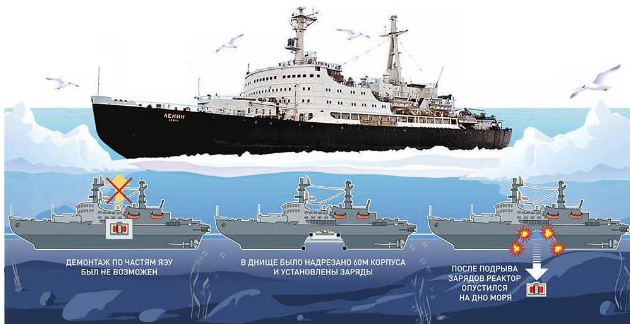
Рис. 2. Выбор варианта выгрузки реакторного отсека АЛ «Ленин»
